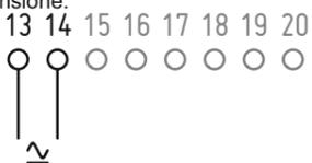
L'alimentazione non deve essere condivisa con altri dispositivi e deve essere conforme alle specifiche per circuiti SELV (EN/IEC 62368). La lunghezza della linea di alimentazione deve essere inferiore a 3m.
