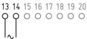
Predisporre un interruttore automatico bipolare o protezione equivalente che assicuri protezione in caso di cortocircuito o sovracorrente
