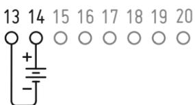
Collegamenti con polarità invertita non danneggiano il dispositivo ma causano una repentina scarica della batteria esterna.
